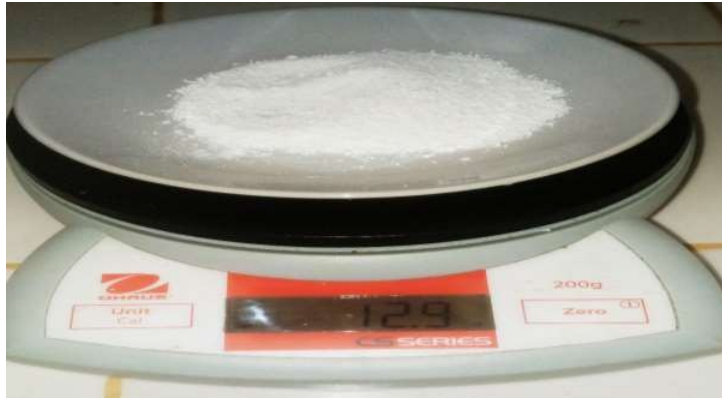
Figure 11. Photographie du citrate de plomb synthétisé sur une balance masse 12.9 g.
